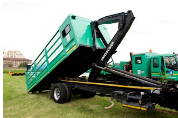
13 Ton Skip Loader ( 2 axles)
