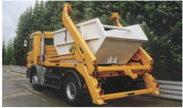
13 Ton Skip Loader ( 2 axles)
