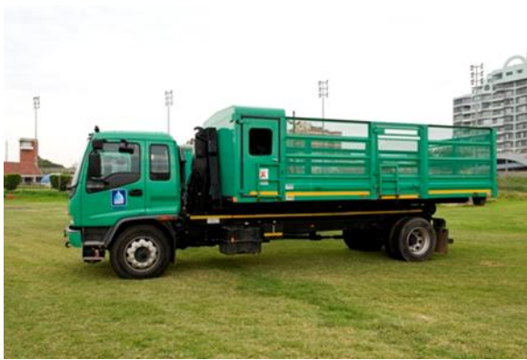
13 Ton Skip Loader ( 2 axles)
