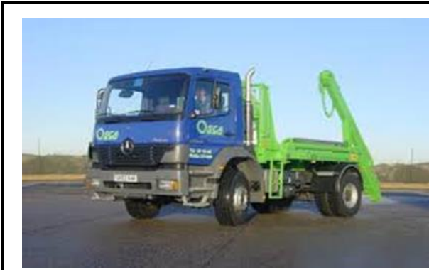
13 Ton Skip Loader ( 2 axles)
